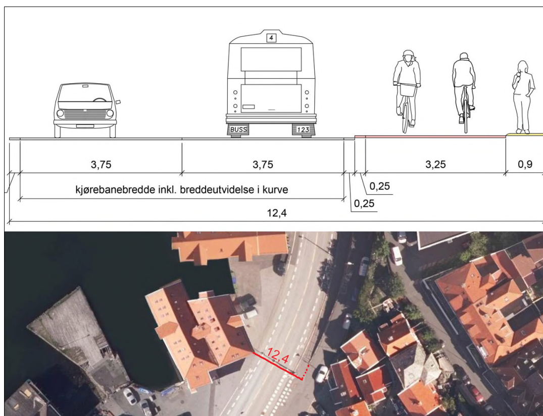
Figur 17: Snittet viser hvordan en eventuell prioritet for tofelts kjørebane ville slått ut i system med sykkelveg med fortau. I dette trange snittet er det knapt plass til fotgjengere. Dette er ikke i henhold til Bergen kommunes prioriteringspyramide, der tilbud til fotgjengere skal prioriteres foran sykkel, kollektivtrafikk og til sist personbiler.
